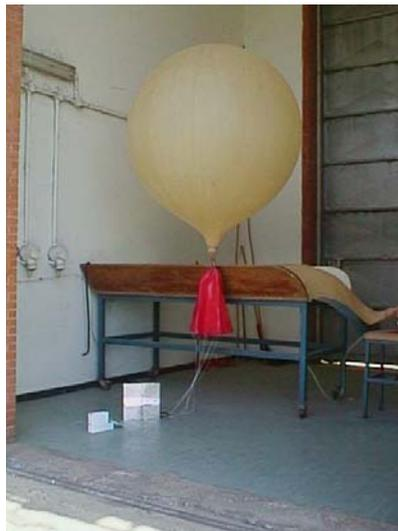
(c) - Pallone utilizzato per il radiosondaggio
