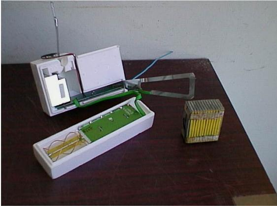
(a) - Sonda - si nota l'antenna ad elica
